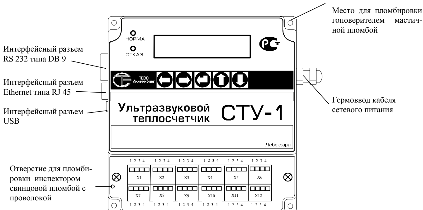
Рисунок 3 - Расположение элементов управления, индикации и разъемов на корпусе СТУ-1 Модель 2
