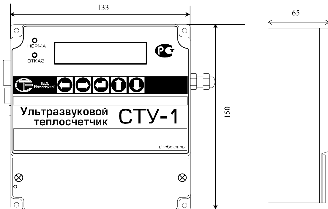
Рисунок 1 - Габаритные размеры УПР и электронного блока
